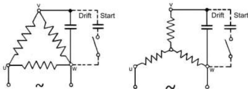
Motoren vil ikke oppnå full effekt som fra et 3-fase nett. Man må passe på at den starter og ikke blir overbelastet.
